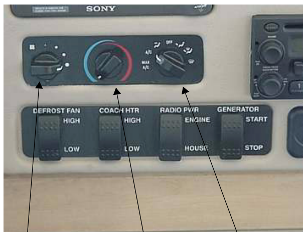
Fan Speed Switch
