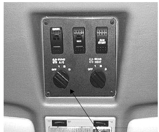
Overhead A/C Fan Control
