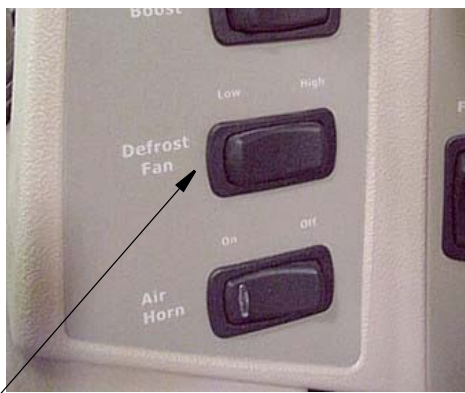
Defrost Fan Switch
